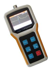
FAR800N Cable Fault Locator è uno strumento portatile progettato per identificare accuratamente guasti resistivi in cavi per telecomunicazioni, coassiali, dati, in alta frequenza ed altro, quali ad esempio corto circuiti, basso isolamento e interruzzioni.
