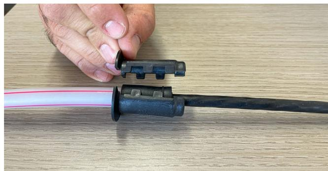
4. **Chiudere** i due semigusci sul cavo, in modo che la guarnizione cada nell'apposita sede.
